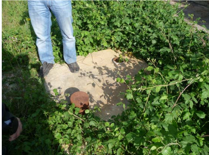
Figure 8 : Photo du piézomètre PZ4
